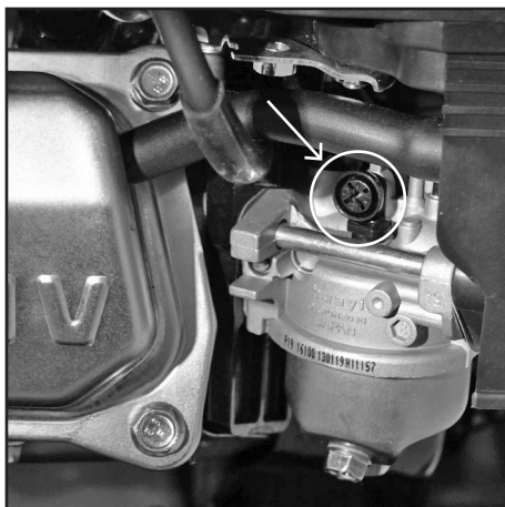
Рис. 13. Винт регулировки холостого хода карбюратора
