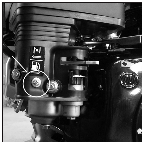
Рис. 14. Место впрыска аэрозоли «Быстрый старт»
